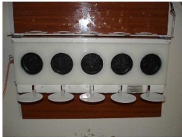
**Рисунок 7 — Электронная мишень для стрельбы с пулькой**
