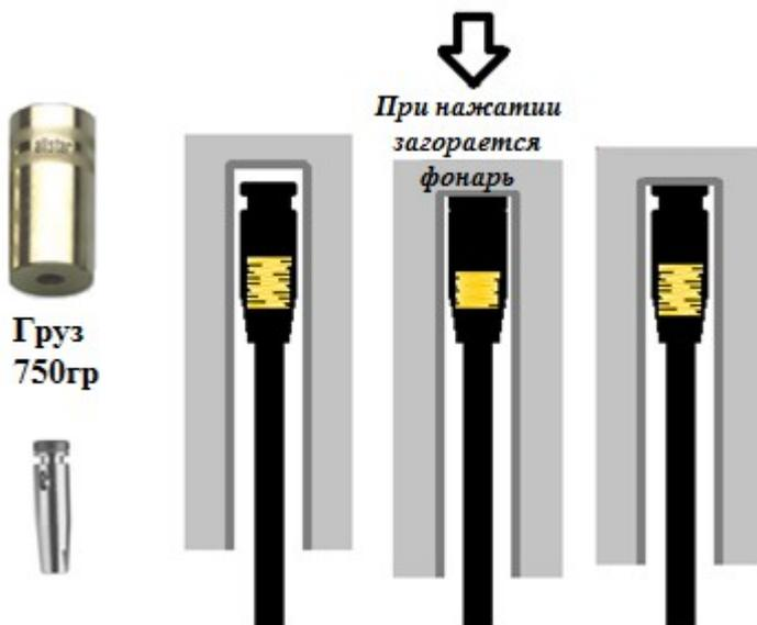
Рис.9. Приспособление, позволяющее измерить ход наконечника (щуп)
