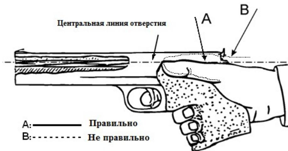
Рисунок 5 — Проверка спуска
